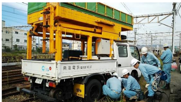
軌道作業用自動車の脱線復旧訓練 (施設部・電力担当)
