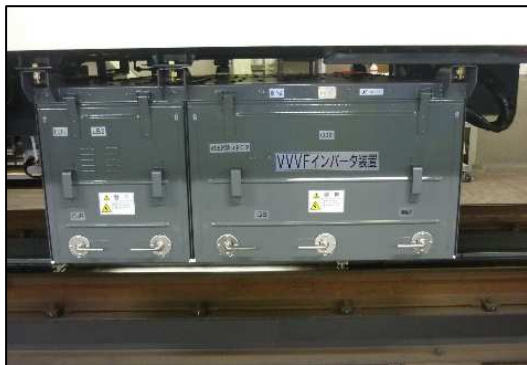
5000系車両VVVF制御装置更
